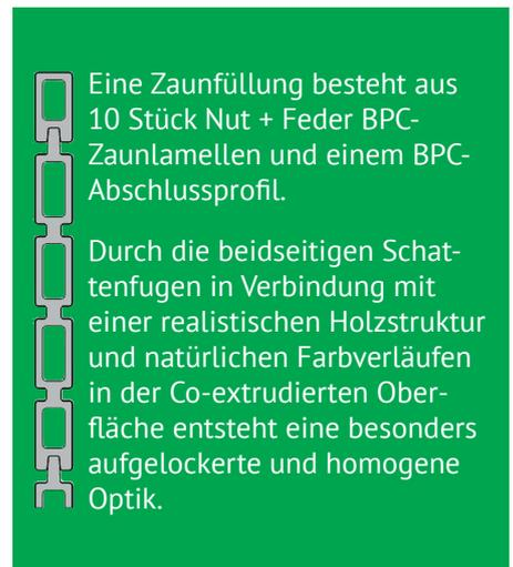
Eine Zaunfüllung besteht aus 10 Stück Nut + Feder BPC-Zaunlamellen und einem BPC-Abschlussprofil.
