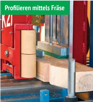
Profilieren mittels Fräse
