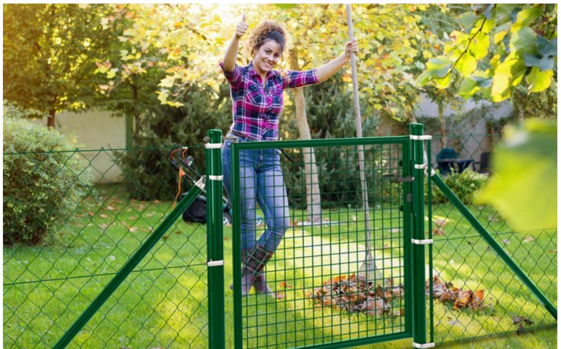
**RANKO GARTEN TORE****Rahmen:** aus runden Stahlrohren, DIN 2394, Ø ca. 38 mm**Füllung:** Schweißgitter 50/4 mm**Pfosten:** aus runden Stahlrohren, DIN 2394, Ø ca. 60 mm, mit Kunststoffkappen**Öffnungsrichtung:** Falle DIN rechts/links verwendbar**Ausstattung:** Rohrrahmenschluss, PZ-vorgerichtet (ohne Zylinder), inklusive Buntbarteinsatz aus Kunststoff mit 2 Schlüsseln, Kunststofftoranschlag**Bei 2-flg. Toren:** Torfeststeller und Auflaufschuh aus Stahl**1-FLÜGELIG**
